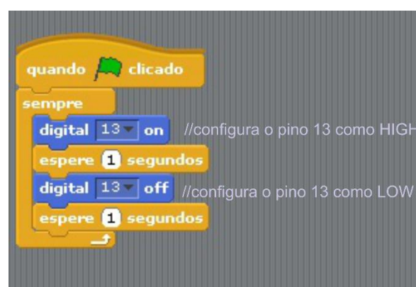
Figura 4 – Programação no ambiente do S4A.
